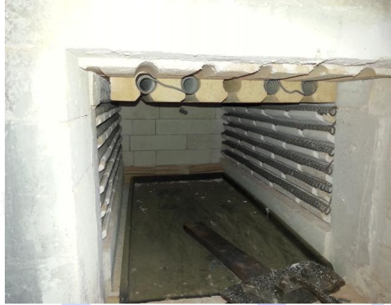
عينة حديد زهر داخل فرن التبريد البطيء
