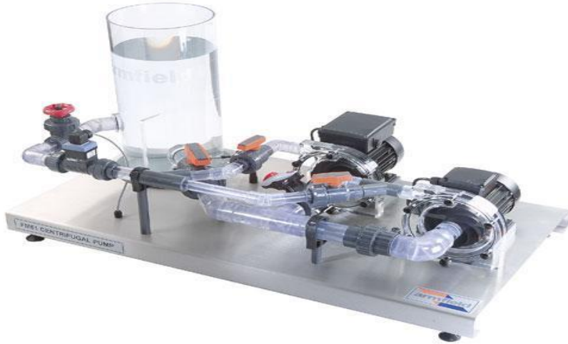
شكل (5-ا) يوضح منظومة المضخات تستخدم للتحقق من كمية الماء ( Q ( m^3/h )) في الحالتين التوصيل على التوازي و التوالي.
