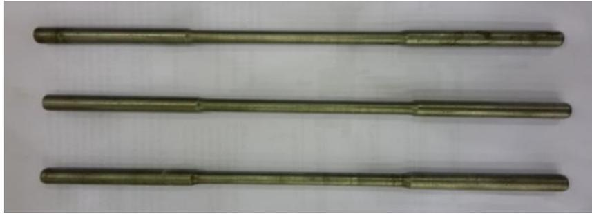
شكل (10). عينة اختبار الشد بعد تجهيزها
