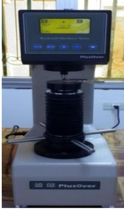
شكل (7). جهاز روكويل لقياس الصلادة
