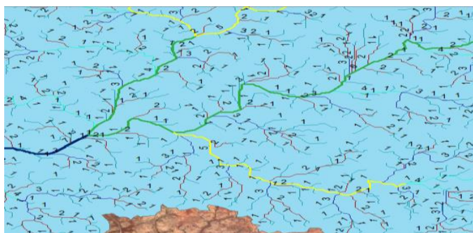
شكل (7) نمط الصرف المائي الشجري بوادي القطارة وفق نتائج برنامج ArcGIS10.5.
