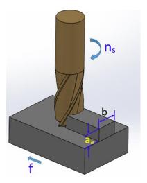
شكل (2). أداة تفريز جانبي حلزونية تقوم بعملية تفريز لقطعة من المعدن
