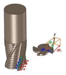
شكل (3). مركبات القوة التفاضلية لعملية التفريز الجانبي
