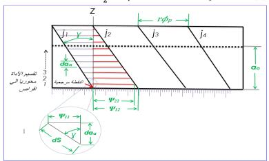
شكل (5). الشكل المنبسط (Unfolded view) لأداة التغريز الجانبي الحازونية حيث أن (D) هو قطر أداة التغريز و  $(\Psi_{ij})$  هي البعد المحيطي للنقطة  $(P_{ij})$ . بالنسبة للإشارة السالبة بالعلاقة (2) هي فقط لتحديد اتجاه حدود قطع أداة التغريز بحيث تكون موجبة عندما تكون الأداة يسارية الاتجاه وسالبة عندما تكون الأداة يمينية الاتجاه، أما زاوية الخطوة  $(\emptyset_n)$  فتحسب من العلاقة  $(S_n)$  كما يلي:
