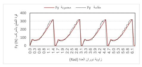
الشكل (14 - ب) مقارنة بين نتائج المحاكاة و نتائج الاختبار العملي لمركب القوة (Fy)
