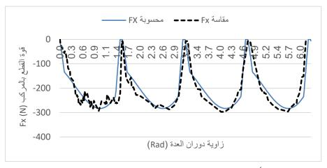
الشكل (14 - أ) مقارنة بين نتائج المحاكاة و نتائج الاختبار العملي لمركب القوة (Fx)
